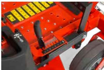
La double transmission hydrostatique permet un contrôle sûr et efficace de la conduite. Robuste protection arrière en acier.
