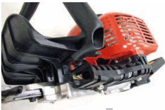
Sortie d'échappement frontale avec protection de l'opérateur.
