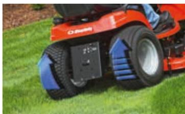
La suspension Confort System™ avec suspensions arrière réduit les chocs ressentis de 25% tout en procurant plus de confort à des vitesses plus rapides.
