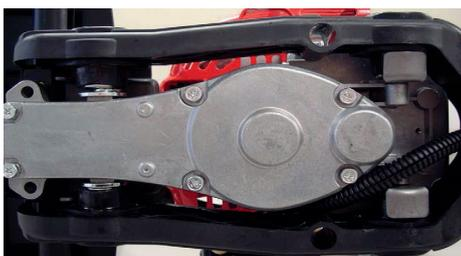
Système anti-vibration (modèle HT239D) composé de ressorts et de caoutchoucs pour réduire la fatigue de l'utilisateur.
