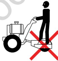
Ne PAS utiliser de Sulky ou tout autre type de plateforme de remorquage avec opérateur sur cette machine car cela dépassera la limite de charge de la transmission. Des dommages permanents à la transmission peuvent survenir, qui ne sont PAS couverts par la garantie.
