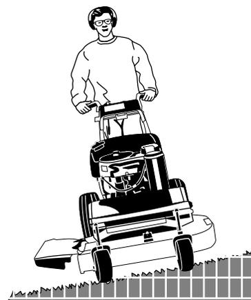
Il existe un danger grave de blessure en cas d'utilisation de cette machine sur une pente trop raide. Utiliser la machine sur une pente trop raide ou sur laquelle la stabilité ou la traction (et le contrôle) est inadéquate peut entraîner la perte de contrôle, voire la chute et la glissade, ou le retournement de l'unité.
