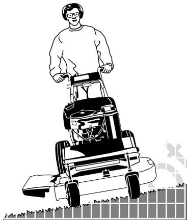
Il existe un danger grave de blessure en cas d'utilisation de cette machine sur une pente trop raide. Utiliser la machine sur une pente trop raide ou sur laquelle la stabilité ou la traction (et le contrôle) est inadéquate peut entraîner la perte de contrôle, voire la chute et la glissade, ou le retournement de l'unité.
