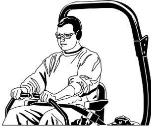
Maintenez l'arceau de sécurité en position relevée et attachez la ceinture de sécurité. Il n'y a aucune protection anti-renversement quand l'arceau de sécurité est abaissé! Ne pas sauter de la tondeuse si elle se renverse (il est plus sûr de rester attaché(e) par la ceinture de sécurité, l'arceau de sécurité étant relevé)
