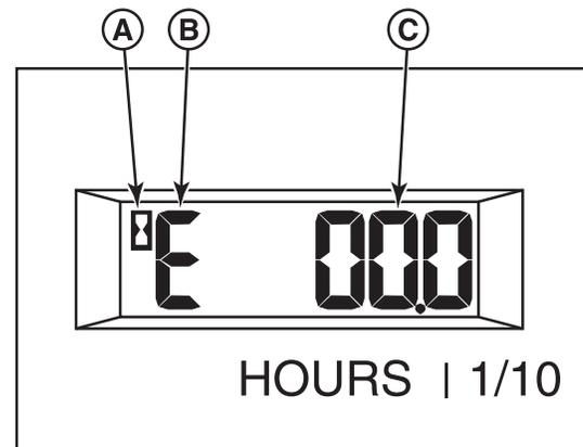
« **A** » -  **Icône loupe des heures** - L'icône loupe des heures clignote lorsque le compteur horaire enregistre l'écoulement du temps.
