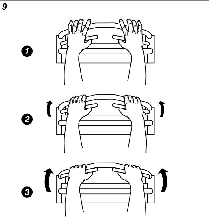
**PREMIÈREMENT**, placer les mains sur les leviers de commande de vitesse et la barre de vitesse d'avancement maximum comme indiqué.
