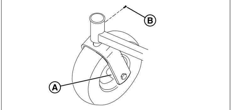
2. Graisser la roue pivotante avant.
