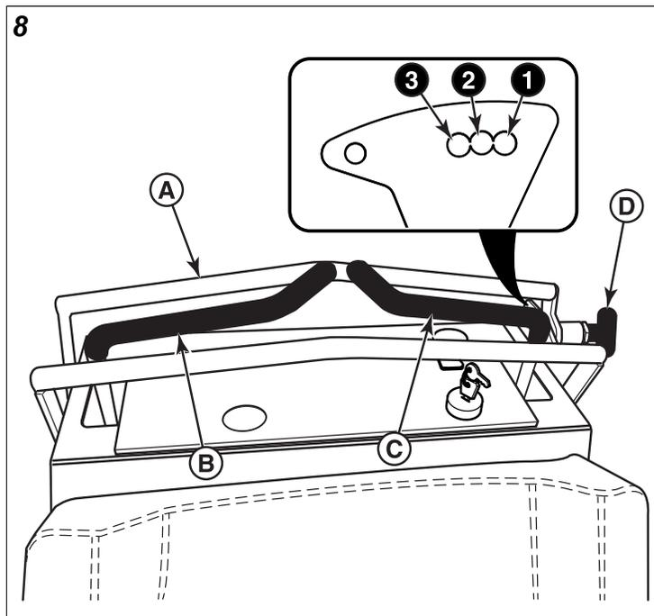
Pour apprendre à conduire la machine, nous recommandons de choisir la vitesse la plus lente (position n°1) jusqu'à ce que l'utilisateur soit à l'aise pour conduire la machine.
