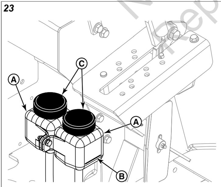
1. Localiser les réservoirs d'huile de transmission. Les réservoirs d'huile de transmission se situent à gauche de l'unité près du boîtier de la goupille de hauteur de coupe.
