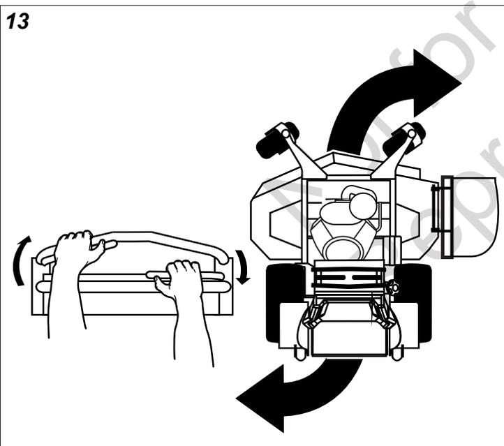
Pour tourner sur place, avec un « rayon de braquage zéro », pousser progressivement le levier de commande de vitesse de déplacement vers l'avant à partir du point mort tout en replaçant simultanément et progressivement l'autre levier au point mort. Recommencer plusieurs fois.
