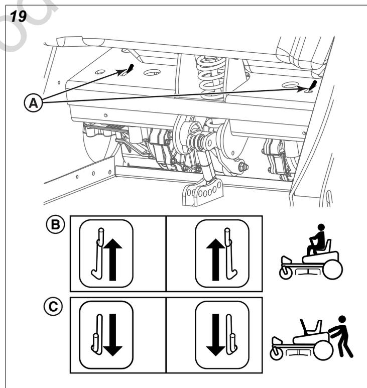
3. Pour ouvrir les soupapes de dérivation de transmission (position « bypass » [dérivation]), tirer les deux leviers de
