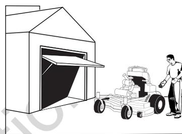
Utiliser cette machine uniquement à l'extérieur et à bonne distance de zones non ventilées, par exemple les garages intérieurs ou les remorques couvertes. Le moteur émet du gaz monoxyde de carbone toxique : une exposition prolongée à ce gaz dans un espace fermé peut entraîner de graves blessures, voire la mort.
