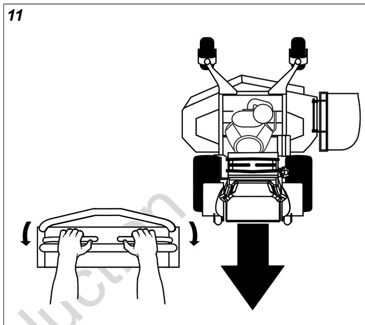
REGARDER EN BAS ET EN ARRIÈRE, puis ramener progressivement et régulièrement les deux leviers de commande de vitesse de déplacement de la position de point mort vers l'ARRIÈRE. Ralentir et recommencer.
