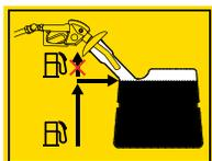
**Danger - Un remplissage excessif du réservoir de carburant peut entraîner un risque d'incendie :** Remplissez le réservoir jusqu'au bas du col de remplissage.
