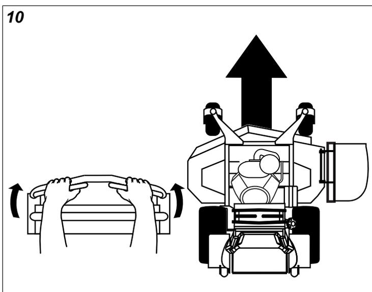
Déplacer progressivement et régulièrement les deux leviers de commande de vitesse de déplacement vers l'AVANT (à partir de la position point mort). Ralentir et recommencer.
