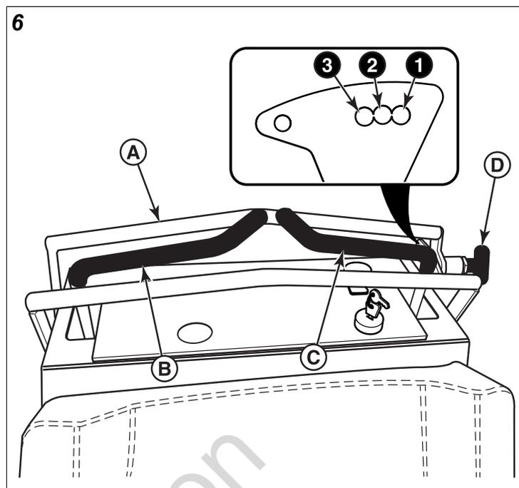
La barre de vitesse maximum est réglable sur trois positions différentes pour s'adapter à la vitesse de déplacement maximale de l'utilisateur. L'orifice de positionnement le plus proche des leviers de commande de vitesse (indiqué en n°1 dans la Figure 6) est le paramètre le plus lent et l'orifice de positionnement le plus éloigné des leviers de commande de vitesse (indiqué en n°3) est le plus rapide.
