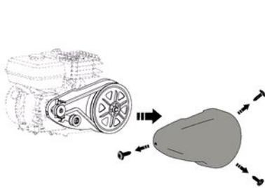
1- Verwijder de 3 bevestigingsschroeven van de drijfriemkap
