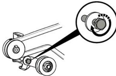
3- Draai de bevestigingsschroef van de as van de koppelingshendel los (2 slagen)
