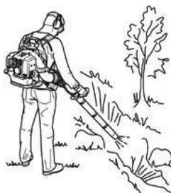
La vitesse du moteur doit être adaptée au type de matériau à enlever, il est rarement nécessaire d'utiliser le plein régime, et de nombreuses procédures de travail peuvent être effectuées à mi-régime : - Si nécessaire, humidifiez la surface à nettoyer afin d'éviter de créer trop de poussière.
