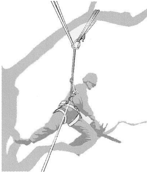
Figure B.3 - Exemple de redirection de la ligne principale via un point d'ancrage supplémentaire
