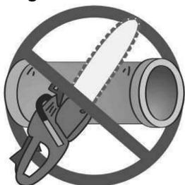
La tronçonneuse ne doit être utilisée que pour couper du bois.
