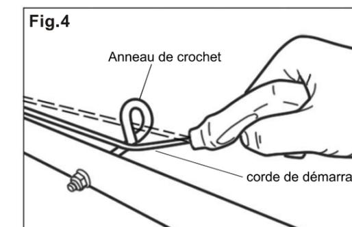
**AVERTISSEMENT :** La position de démarrage du moteur de sécurité est à l'arrière de la poignée supérieure. Les utilisateurs doivent garder la corde toujours au milieu de l'anneau de crochet pendant le démarrage du moteur et le travail de tonte. Il est un danger pour démarrer le moteur loin de la position de sécurité, ce qui conduira au risque de blesser les pieds.
