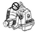
Ne placez aucune partie de votre corps dans la zone marquée. Le contact peut entraîner des brûlures de la peau ou un choc électrique si le capuchon de la bougie a été endommagé.
