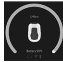
Rapport général de l'état du robot. Niveau de batterie, connexion, type de connexion et indicateur de pluie.
