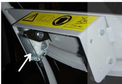
**B** - Assembler le guidon sur la machine. Le réglage de la hauteur du guidon se fait à l'aide d'une poignée agissant sur les pièces crantées. Cela vous permettra de choisir la hauteur des mancherons la mieux adaptée à votre morphologie.
