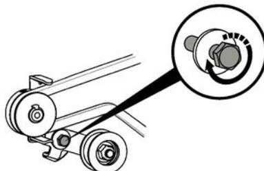
3- Svitare le viti di fissaggio dell'asse della leva della frizione (2 giri)
