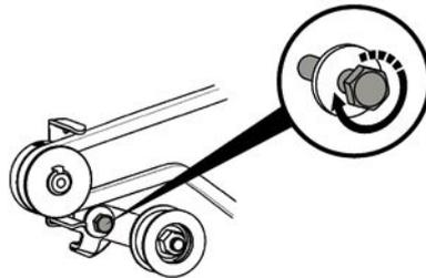
3- Draai de bevestigingsschroef van de as van de koppelingshendel los (2 slagen)
