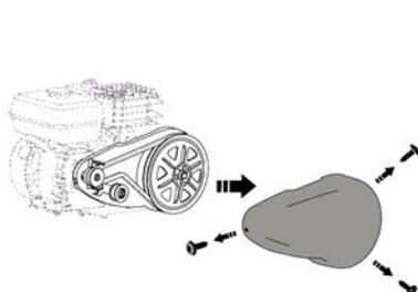
1- Retirar los 3 tornillos de fijación de la cubierta de correa
