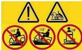
**▲ DANGER!** *RÉDUISEZ VOTRE VITESSE AVANT TOUT CHANGEMENT DE DIRECTION DANS UNE PENTE et serrez toujours le frein de stationnement avant de laisser la machine à l'arrêt sans surveillance.*
