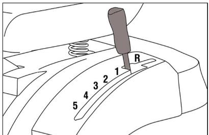
Lorsque vous déplacez le levier de changement de vitesse, appuyez sur la pédale de frein pour désengager la courroie de transmission et déplacez le levier pour engager la vitesse correspondante comme indiqué sur l'étiquette.
