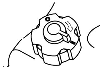
– Lors d'un démarrage à froid, placez le levier de commande des gaz sur la position « STARTER » comme représenté sur l'étiquette ;
