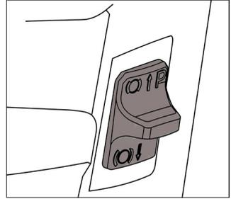
le frein de stationnement, appuyez à fond sur la pédale de frein (le levier de frein de stationnement est automatiquement déverrouillé et revient en position basse).
