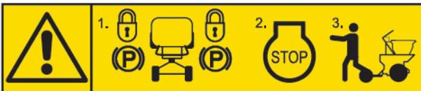
Avant de quitter le poste de conduite, actionnez les deux freins de stationnement et arrêtez le moteur.
