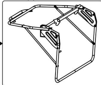
Remarque : Lors de l'installation, les renforts de maintien latéraux (5) sont à monter sur le côté intérieur du support avant (4) et du cadre supérieur (3).
