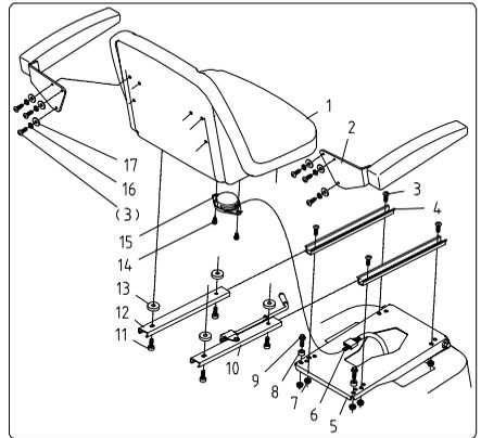
2. Installez les éléments du contacteur de siège (n° 15) à l'aide des vis M6x16 (n° 14).
