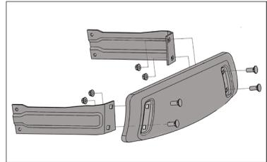
b. Montage du pare-chocs avant sur le châssis à l'aide des 4 écrous M8 et des 4 vis M8x20. (Utilisez la clé plate 13-15 fournie dans le kit outillage).
